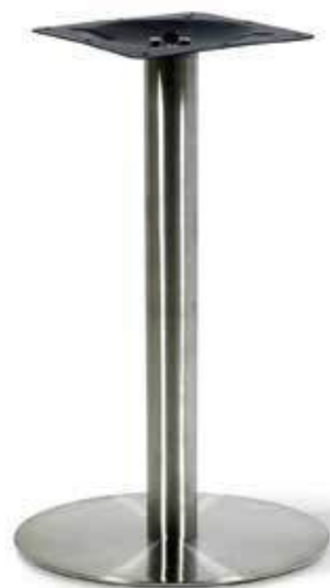
Articolo LF812 Basamento in resina con rivestimento in metallo silver Ø. 40 cm. tubo ferro silver Ø. 6,3 cm. altezza fissa 72 cm. piastra fissaggio piano 25x25 in acciaio stampato peso 7,5 kg. Basement in resin with metal coating silver Ø. 40 cm. silver iron pipe Ø. 6.3 cm. fixed height 72 cm. 25x25 top fixing plate in pressed steel weight 7.5 kg.
